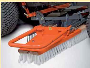
Щётки регулируются по ширине для процесса чистки (2.000 мм) или для процесса ухода (2.400 мм)
